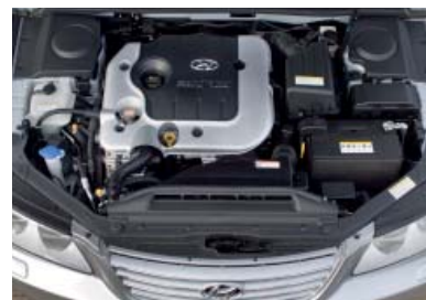
De 2.2 CRDi-motor heeft beschaafde manieren en levert 155 pk, wat ondanks het forse gewicht van bijna 1.700 kg adequaat is voor de grote Hyundai.
