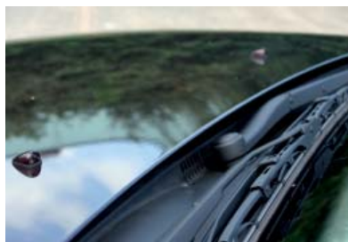
Oogt goedkoop: de ruitensproeierkoppen steken ver boven de motorkap uit en zitten zo in het blikveld. Daar zijn fraaiere oplossingen voor.
